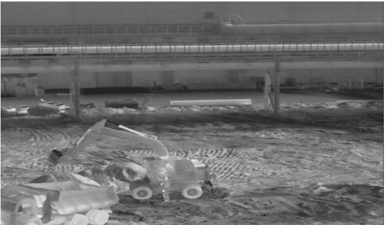
Рис. 1. Кадр с камеры известного российского производителя на основе всё того же французского микроболометра на аморфном кремнии. Камера без затвора. «Сырое» изображение.
