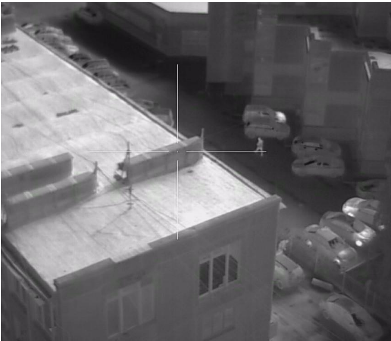
Рис. 2. Кадр, сделанный камерой КБ ВиТА на основе китайского термостабилизированного микроболометра GWIC. Камера с затвором. 18-кратное сжатие изображения.
