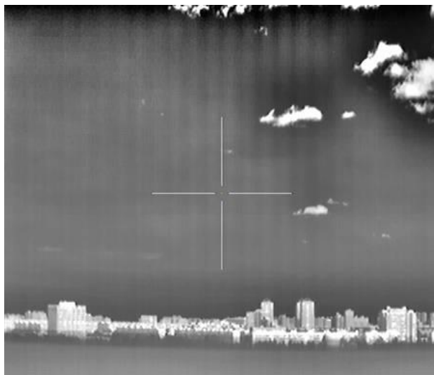
Рис. 3. Стандартная ситуация в работе оператора, когда в кадр одновременно попадает холодное небо (около -50^{\circ}\text{C} ) и тёплая подстилающая поверхность. АРУ (автоматическая регулировка усиления) любого модуля обрабатывает по среднему значению сцены, в результате, часть кадра становится малоконтрастной или же имеет перенасыщенный контраст, за счёт чего оператор теряет значительную часть информации. Слева – типовой пример работы модуля при съёмке объектов с большим температурным контрастом, справа – пример работы алгоритма локального контрастирования.
