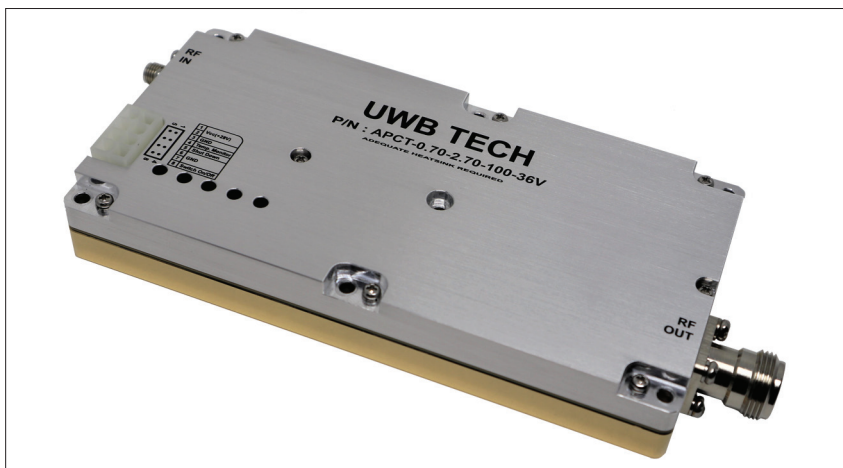
▲ Рис. 1. Внешний вид твердотельного усилителя APCT-0.70-2.70-100-36V
