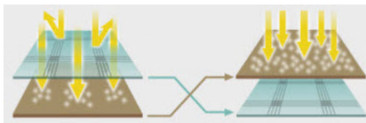
На приведенном выше рисунке слева показана конструкция обычной КМОП матрицы, справа – КМОП матрицы с задней подсветкой.
